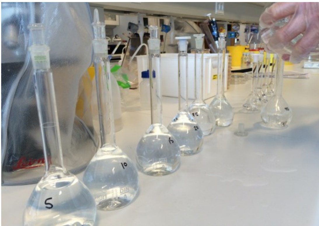
Figur 1. Opsætning af standardrække for test af nitratmåleudstyr omkring en standardkurve. Fotos af Camilla Vestergaard, SEGES
